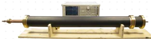
Banc de mesure d'impédance de transfert méthode triaxiale, conforme NF EN 50289-1-6
